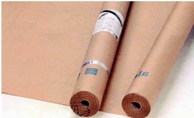
**Propriétés :** La faible valeur Sd du PARALEX 500 permet la réalisation de toits et de murs hautement diffusants, très résistant à la déchirure. Lorsqu'il est utilisé sur des murs à ossature bois isolés avec de la cellulose, il résiste à la poussée de cette dernière, lors de l'insufflation, dès lors qu'il est collé et latté contre l'ossature.
